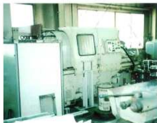
■NC旋盤 森精機製 最大加工寸法 φ1600×L1000mm
