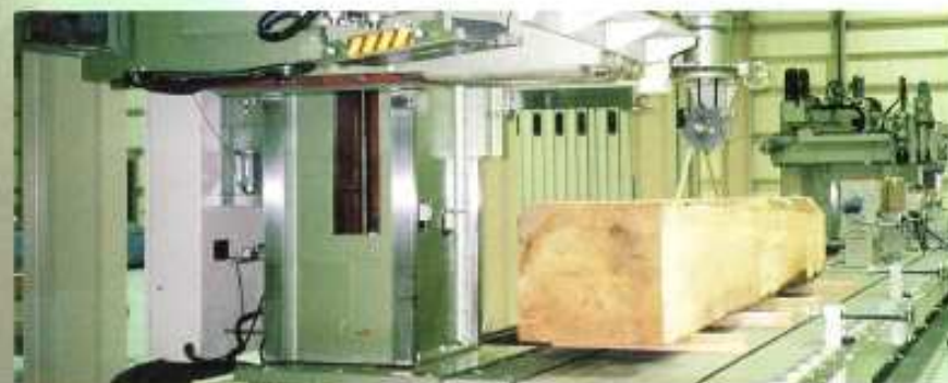
■社寺・仏閣・建築用複合加工機 HFP-12000-3NC型
