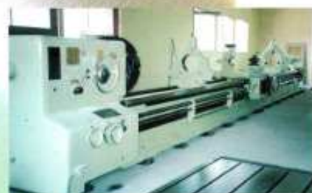
■大型旋盤 大隈鉄工製 最大加工寸法 φ1600×L1000mm
