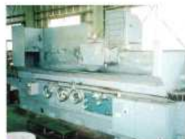
■平面研磨盤 岡本理研製 最大加工寸法 W500×L2000mm
