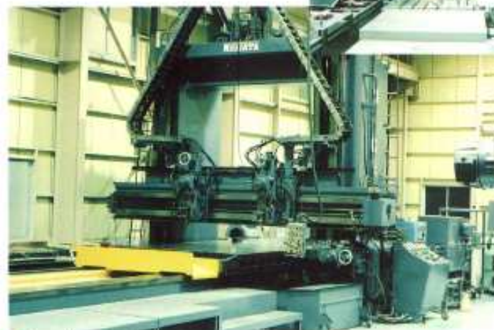
■プレーナー 新潟鉄工製 最大加工寸法 W3000×L10000mm
