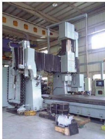
2 m×5 m 大隈鉄工5面加工機
