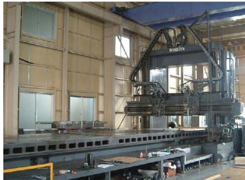
3m×14m 新潟鉄工製 プレーナー
