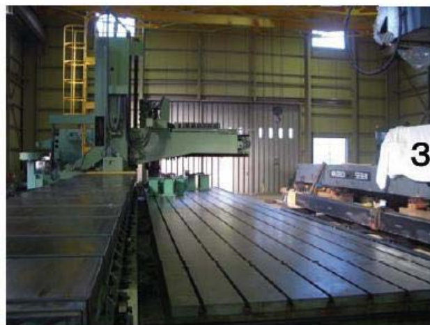
3m×14m 新潟鉄工製 プレーナー
